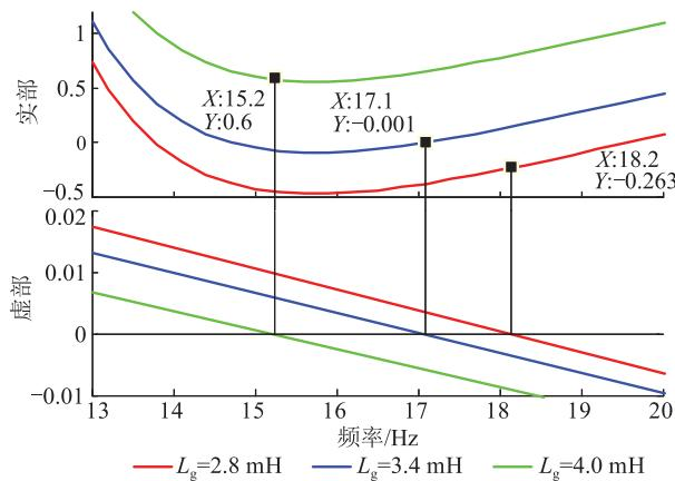
图 5 系统电抗对总阻抗行列式  $D(s)$  阻抗-频率特性影响
