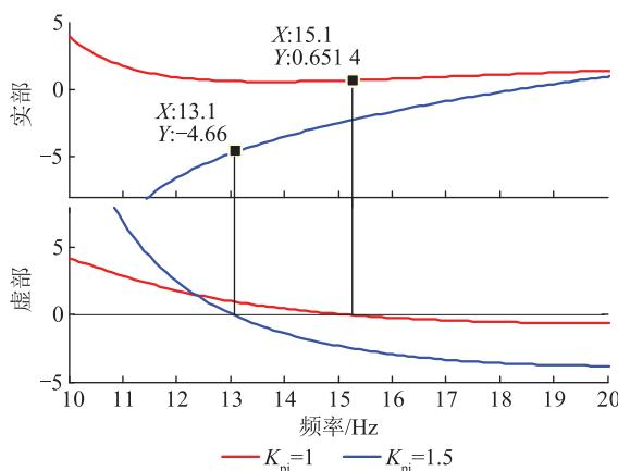
图 6 电流内环比例增益  $K_{pi}$  对  $D(s)$  阻抗-频率特性的影响
