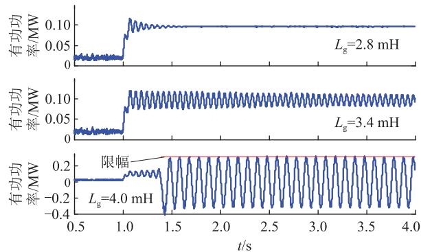
图8 风电机组输出有功功率波形
