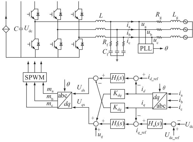
图 1 直驱风电机组并网系统电路结构及控制示意
