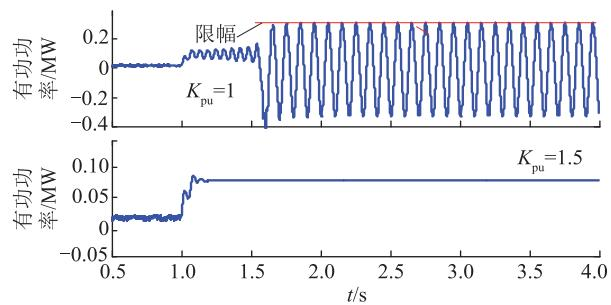
图10 直流电压 $K_{pu}$ 不同时风电机组输出有功功率波形
