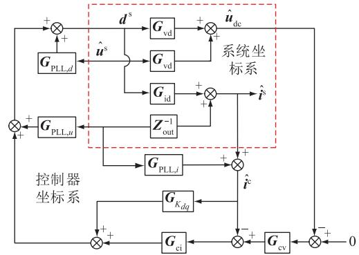
图 2 风电机组阻抗模型
