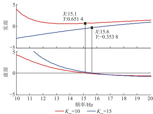
图 7 直流电压外环  $K_{pu}$  对  $D(s)$  阻抗-频率特性的影响
