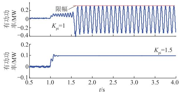
图9 电流内环 $K_{pi}$ 不同时风电机组输出有功功率波形
