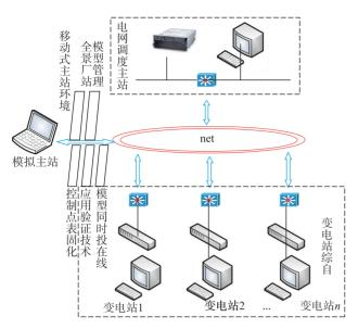
图 1 模拟主站架构示意图
