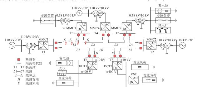
图 1 多端柔性直流配电系统拓扑
