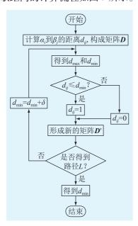
图 5 弗雷歇距离算法流程
