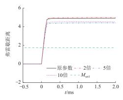
图 13 不同线路分布电容的弗雷歇距离 Fig.13 Fréchet distance of different line distributed capacitances
