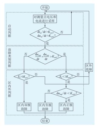
图 6 保护原理流程
