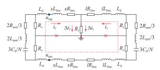
图 4 单极故障的等值电路
