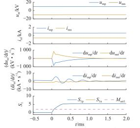
(a) 电压、电流及其变化率和电压弗雷歇距离积分的波形
