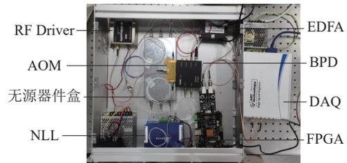
图 2 硬件系统连接
