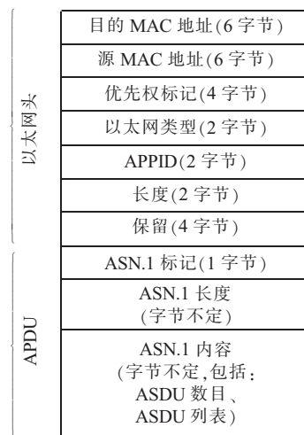
图1 IEC 61850-9-1 协议格式
