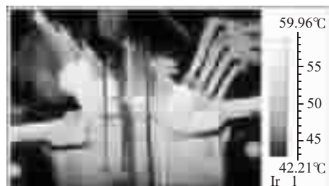
图1 运行中的变压器红外线成像图
