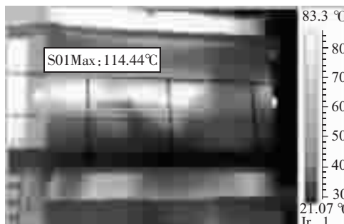
图9 锅炉炉壁外线成像图
