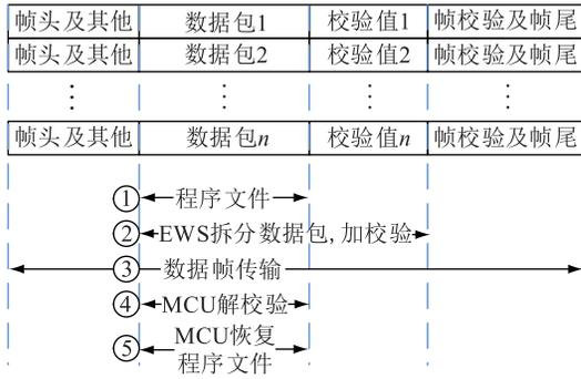
图8 端到端校验的多数据包传输
